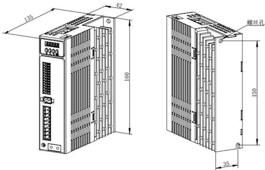
图 3.1 C600S-40/C600S-75 系列外形尺寸图
