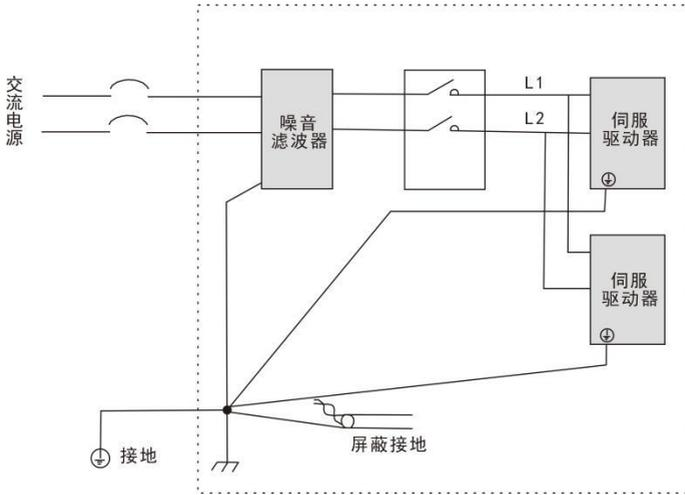
图 4.16 噪音滤波器地线处理示意图
